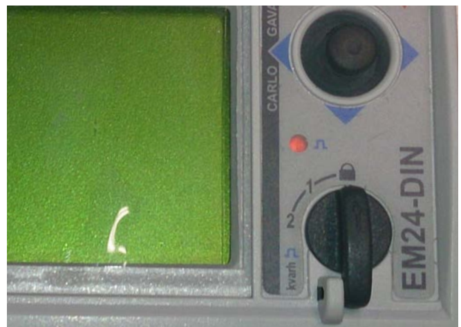
Abb. 20: Betriebsartenwahlschalter auf Schloss-Stellung
