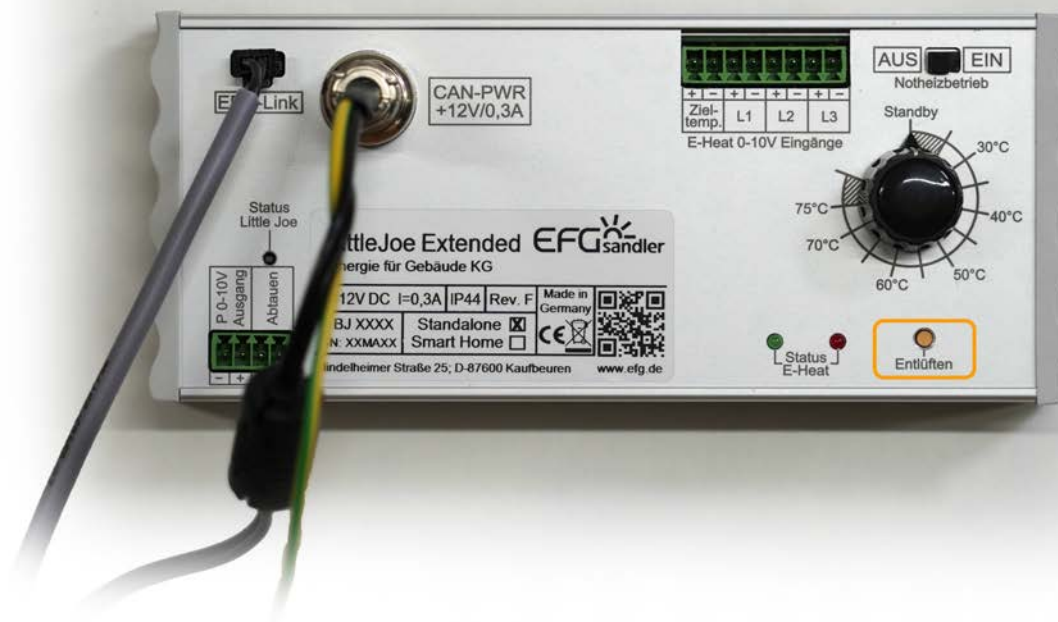
Abb. 32: Der Entlüften-Knopf am LittleJoe Extended
