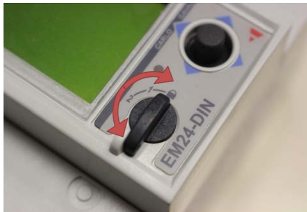
Abb. 18: Betriebsartenwahlschalter des EM-24-DIN
