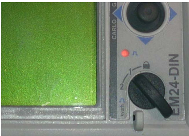
Abb. 19: Betriebsartenwahlschalter auf Stellung 1
