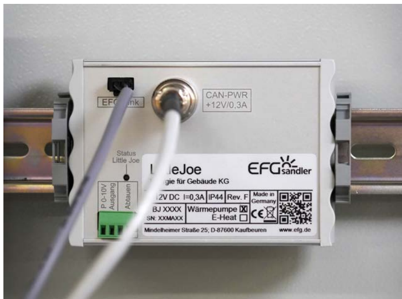
Abb. 34: Kommunikationsmodul LittleJoe mit CAN-PWR Stecker (rechts)
