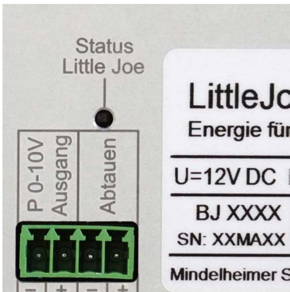
Abb. 12: Digitaler Eingang für das Wärmepumpen-Abtausignal am LittleJoe
