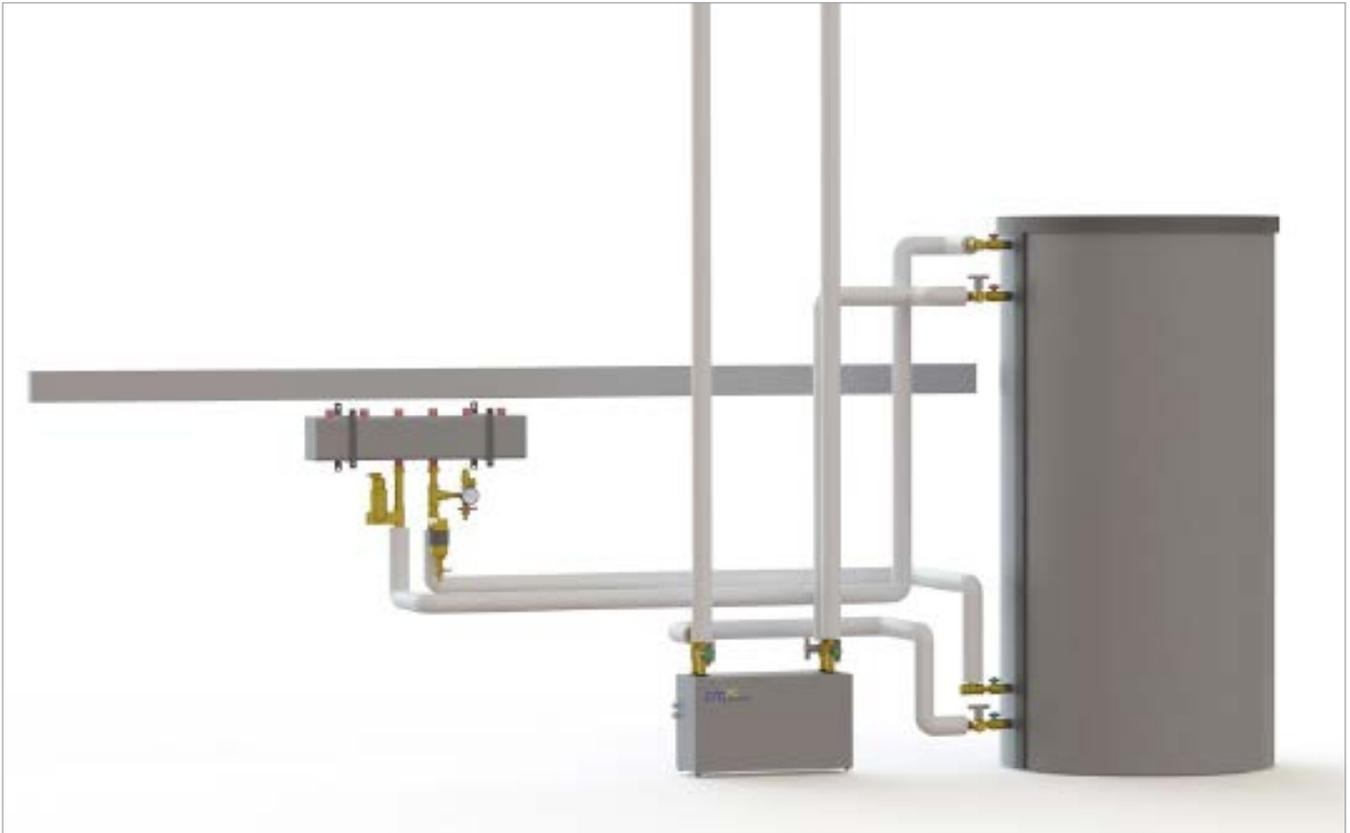
Der thermisch getrennte Systemverteiler ist das Bindeglied zwischen den Hydraulikmodulen und den Speichern. Bei der Installation des Systemverteilers ist auf ausreichend Platz zu achten, um eine eventuelle spätere Erweiterung zu erleichtern.
