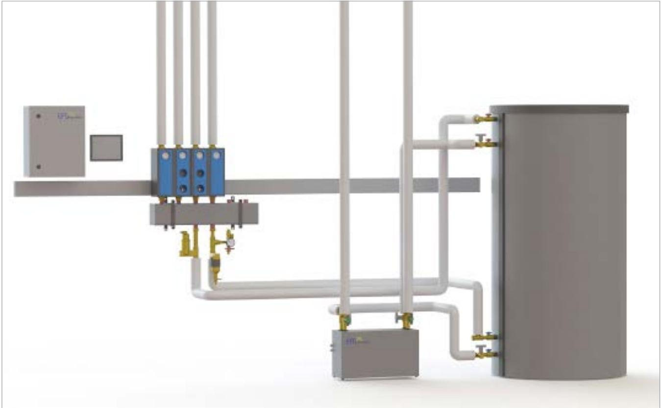
Jedes WärmeAbgabeModul ist hydraulisch und elektrisch vorgefertigt und muss lediglich auf den Absperrarmaturen auf dem Systemverteiler montiert und mit der jeweiligen Wärmeabgabe verbunden werden. Die Kabel können einstweilen im Kabelkanal Richtung Regelungsschrank vorgezogen werden. Die Verbindung zum Regelungsschrank wird in Kapitel 8 beschrieben.
