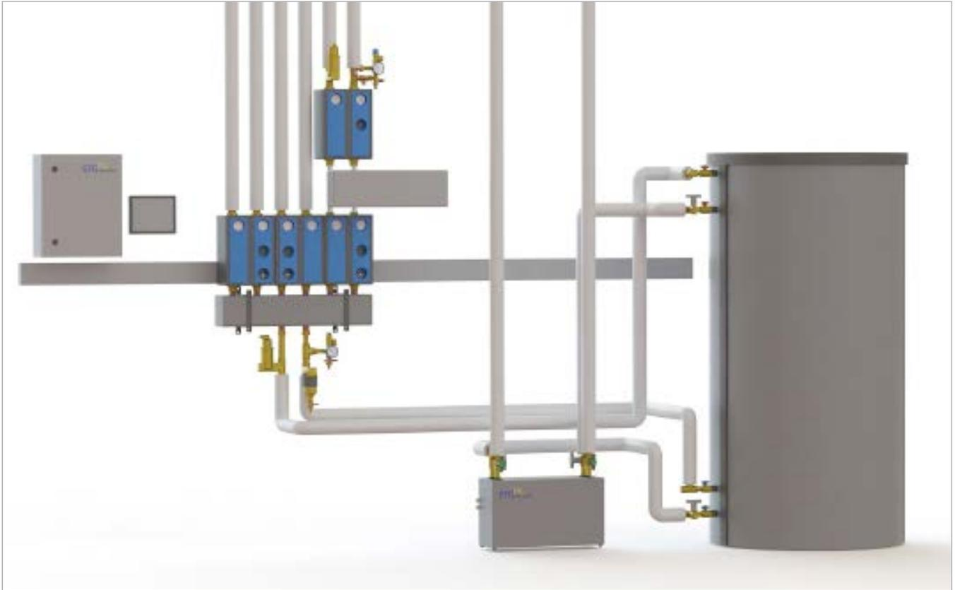
Das SolarThermieModul ist hydraulisch und elektrisch vorgefertigt und muss lediglich auf den Absperrarmaturen auf dem Systemverteiler montiert und mit dem Solarkollektorfeld verbunden werden. Die Kabel können einstweilen im Kabelkanal Richtung Regelschrank eingezogen werden. Die Verbindung zum Regelschrank wird in Kapitel 8 beschrieben.
