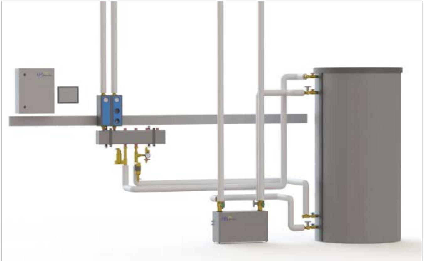
Jedes WärmeErzeugerModul ist hydraulisch und elektrisch vorgefertigt und muss lediglich auf den Absperrarmaturen auf dem Systemverteiler montiert und mit dem jeweiligen Wärmeezeuger verbunden werden. Die Kabel der Module können einstweilen im Kabelkanal Richtung Regelungsschrank eingezogen werden. Die Verbindung mit dem Regelungsschrank erfolgt in Kapitel 8.
